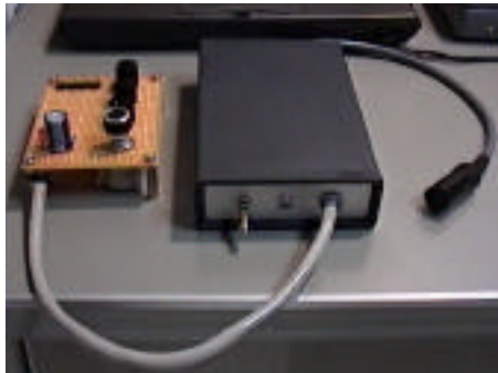
図11 汎用アナログ-MIDIコンバータの外形
