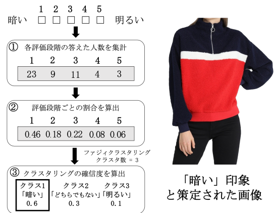
図 1 右の画像が印象項目「暗いー明るい」から「暗い」印象であると策定されるまでの手順。3 つのクラス「暗い」「どちらでもない」「明るい」から確信度の高いクラスに策定される。
