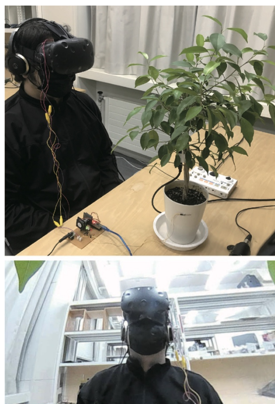
図3. 実験中の様子(上段：実験装置を装着した実験参加者、下段：HMD内のディスプレイに描画された植物側の視界)
