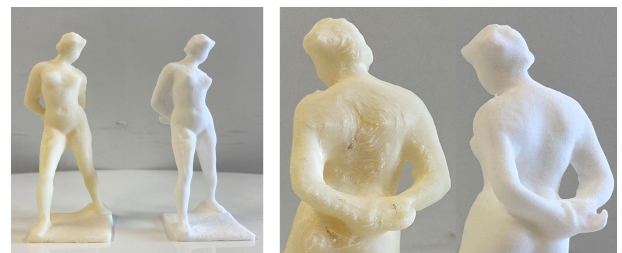
図 2 “Action in Chains” の Gen 1 のデータを積層方式 (左) と粉末焼結方式 (右) で 3D プリントした結果の比較、右の図は結果の差の激しい背中部分。
