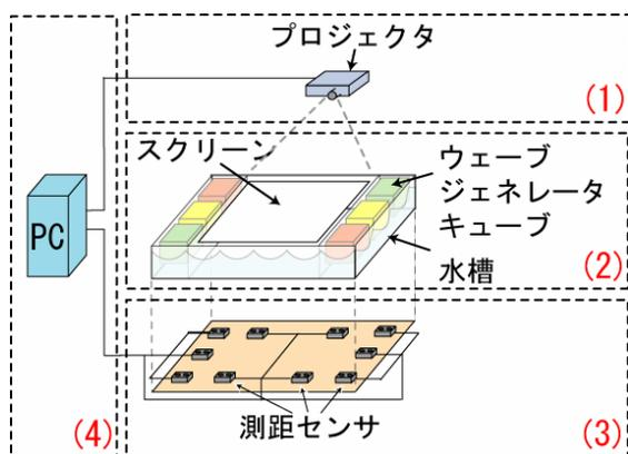
図 11: トント Ver.2 のシステム構成図
