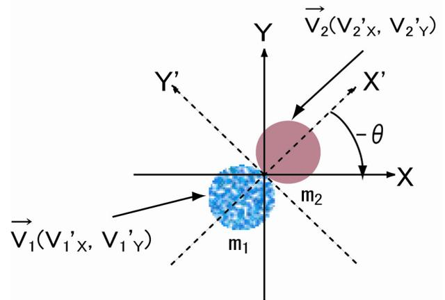
図8: 仮想球による衝突後の挙動の計算
