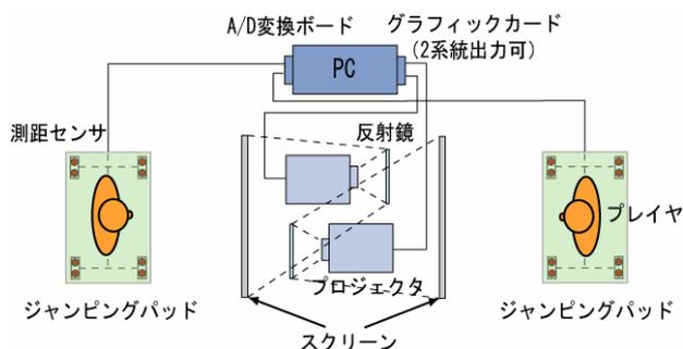
図 1: トントン Ver.1 のシステム構成図
