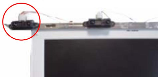
図2 赤外線測距センサの設置
