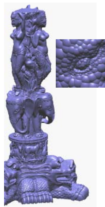
図2. 複雑な3次元形状の例。 小窓は局所的な曲面の有効範囲を表した球。
